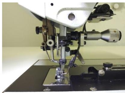
Dispositivo punto morbido con regolazione micrometrica. Ruotando la manopola zigrinata in senso orario si aumenta la morbidezza del punto superiore, ruotandola in senso antiorario la si diminuisce.
